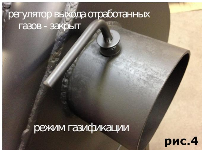
Разожгите дрова в районе топки, после чего закройте топочную дверцу на запорное устройство, через 2-5 минут убедитесь что огонь разгорелся, прикройте регулятор подачи воздуха и только после этого перекрывайте регулятор выхода отработанных газов (рис. 3;4), тем самым вы перевели печь из интенсивного режима работы в режим газификации. Данный режим является самым эффективным и экономичным, выдавая максимальный КПД и время работы.
